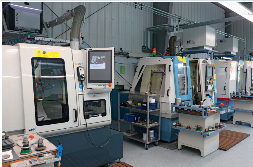
2 Zurzeit sind sechs 5-Achs-Werkzeugschleifmaschinen an die Knoll-Zentralanlage angeschlossen © Knoll
